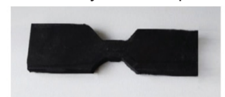
FIGURA 8. Probeta de placa de neopreno para los ensayos de tensión y alargamiento.
